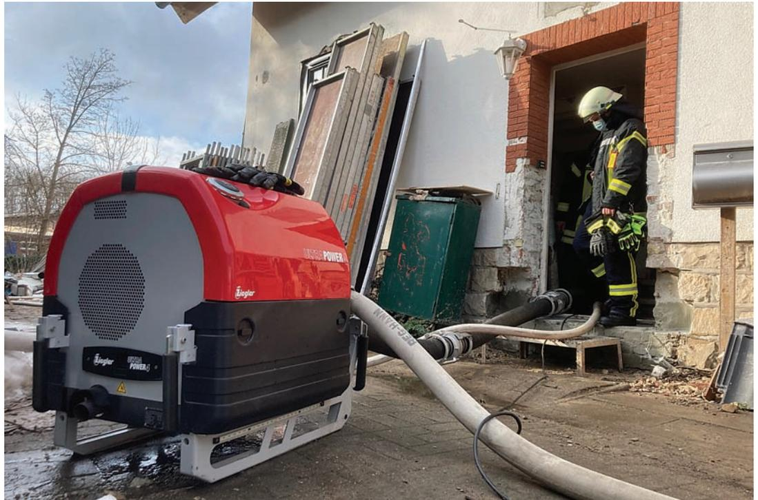
Mit einer Tragkraftspritze wird das Wasser aus dem Keller eines Hauses in Koldingen gepumpt.
